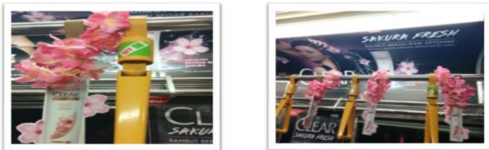
Gambar 2. Hand Grip ( Hand Grip , adalah pegangan tangan yang diperuntukkan bagi penumpang yang berdiri di kereta, pegangan tangan ini menggantung tepat di atas penumpang, ukurannya 10 cm x 10 cm).
