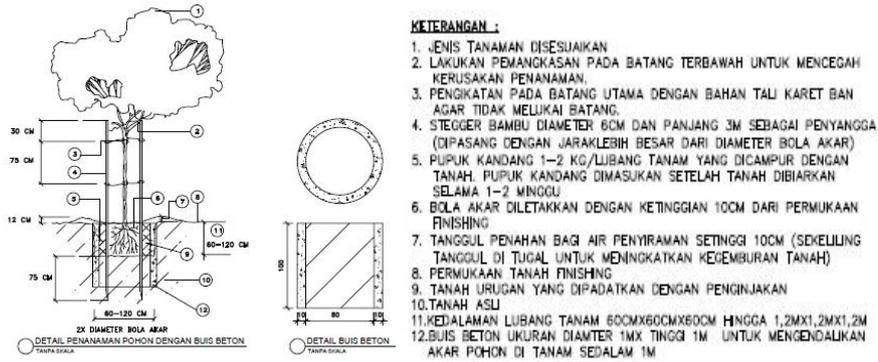
Gambar 13. Detil penanaman dan konstruksi dinding penahan akar(modifikasi [18])
