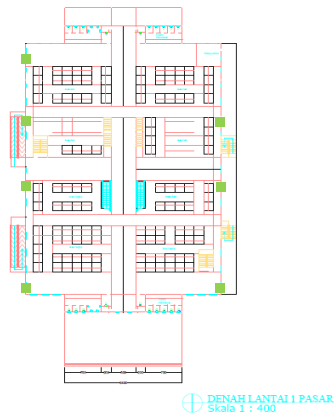
Gambar 14. Peletakan Hydrant Box Dalam Bangunan Sumber : (Olahan Pribadi,2020).
