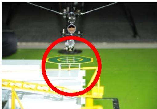
Gambar 7 Posisi FHP di atas helideck model FPU.
