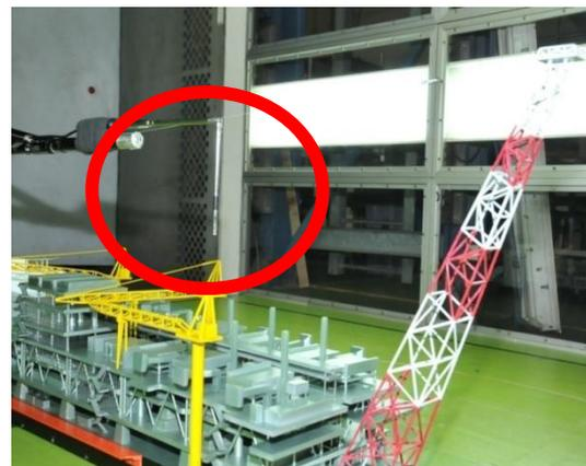
Gambar 5 Posisi anemometer TA460 di model uji FPU.
