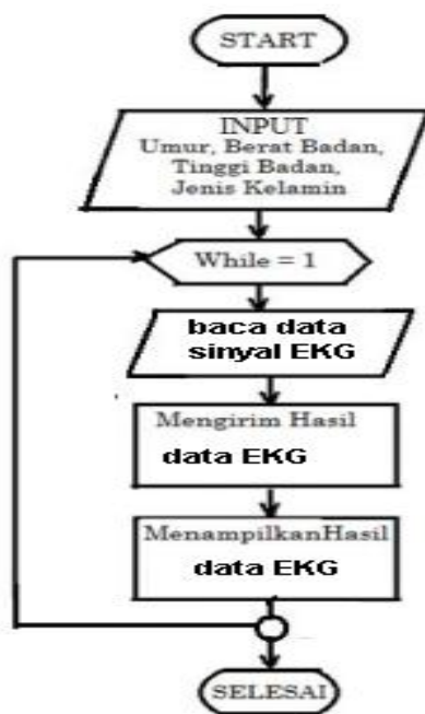
Gambar 2. Flow chart alur perangkat lunak pada telepon seluler
