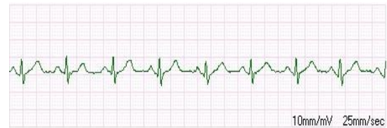
Gambar 6. Hasil dari pengukuran pengambilan data dari AD8232 serial ke computer
