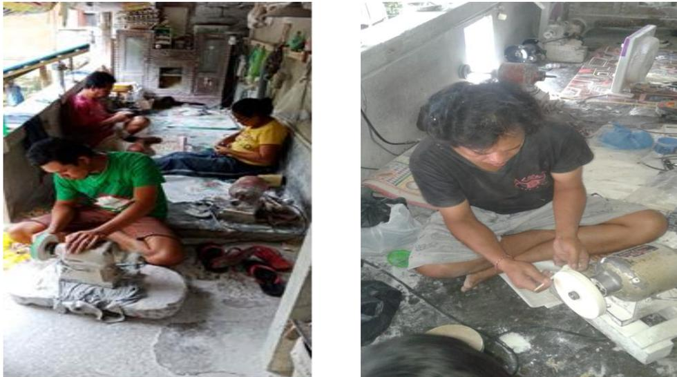
Gambar 2. Kondisi Tempat Produksi yang Kotor karena Debu Sisa Kerajinan dan Para Pekerja Tidak Memakai Sepol Tangan dan Penutup Hidung Saat Proses Produksi.
