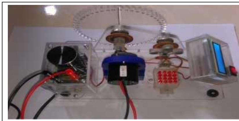
Gambar 2.3. Bagian generator listrik
