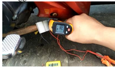
Gambar 6. Pengukuran Suhu dengan Menggunakan Termometer Tembak
