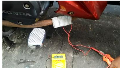
Gambar 5. Rangkaian Paralel Termoelektrik yang akan dilakukan Pengukuran
