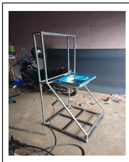
Gambar 4. Rangka alat cuci tangan otomatis
